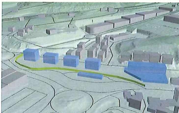
Figura 10. Pantalla acústica en la futura urbanización del ámbito de Mendipe.
