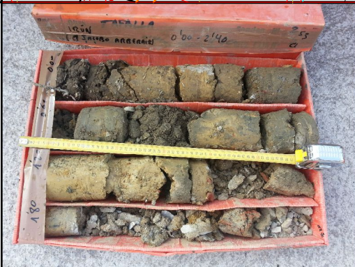
Cajas N°1 ( 0,00 - 2,40 m) y n° 2 (2,40 a 5,40 m)
