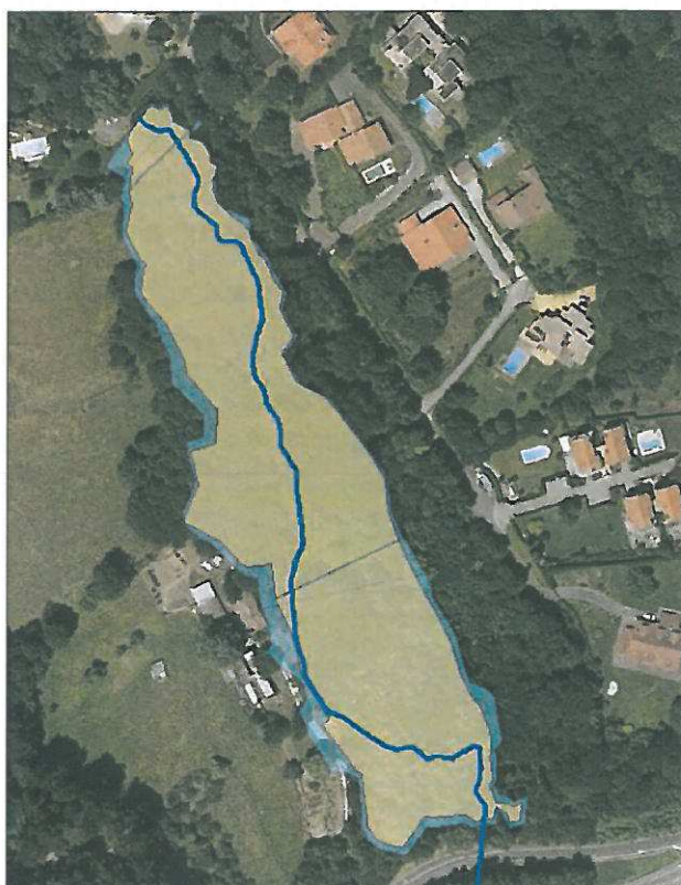
Figura nº 9.- Manchas de inundación en el ámbito urbanístico analizado. Fuente: SALABERRIA INGENIERITZA, S.L (2018).
