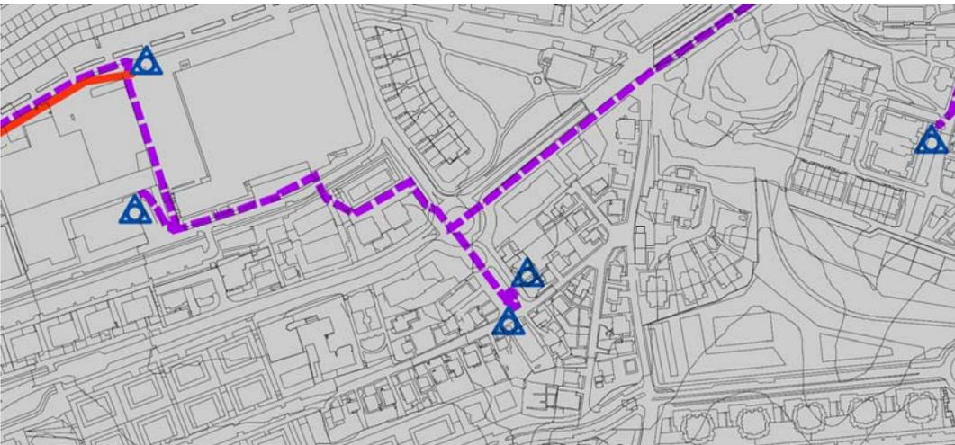
**PLANO E09 S3 /RED DE SUMINISTRO DE ENERGIA ELECTRICA :** EN COLOR MORADO, LÍNEA SUBTERRÁNEA DE 30 KV (SISTEMA LOCAL) / TRIÁNGULO CON CÍRCULO INSCRITO, CENTRO DE TRANSFORMACIÓN (SISTEMA LOCAL)
