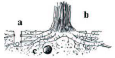
Fig.4: Paso de servicios “zanjas” por la zona de protección. A: zanja abierta en zonas alejadas. B: zanjas con “air spade” en proximidades del tronco con elevada presencia de raíces. C: túnel en caso de pasar muy cerca o por debajo del árbol.
