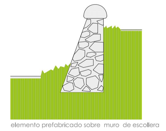
elemento prefabricado sobre muro de escollera
